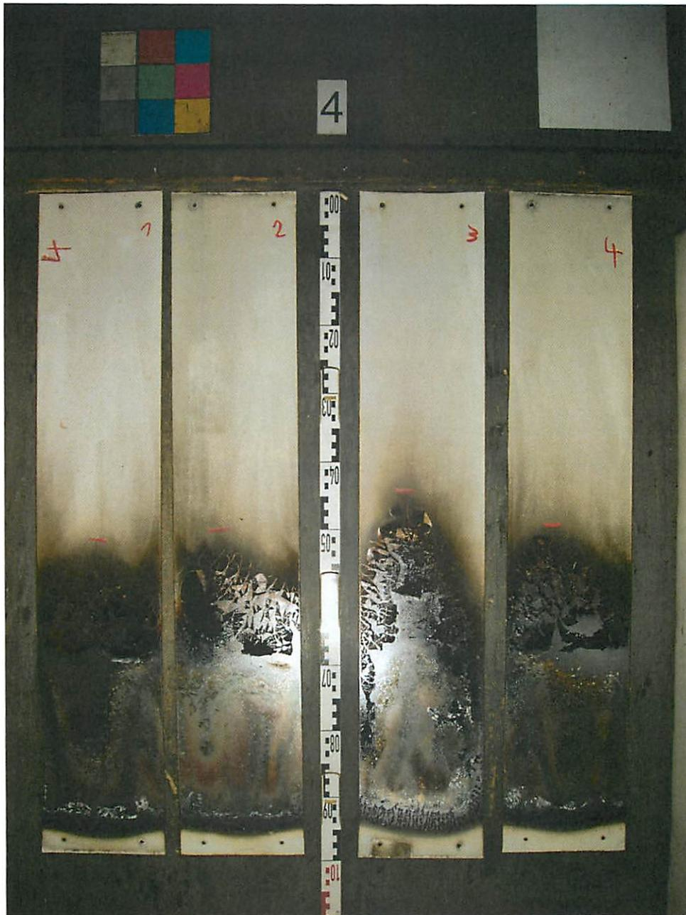
Bild 1: Aussehen des Probekörpers A nach dem Brandschachtversuch
